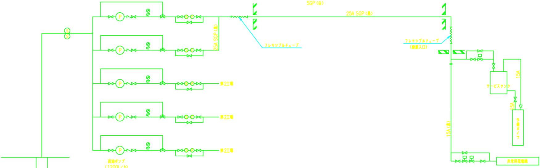
燃料油配管系統図
